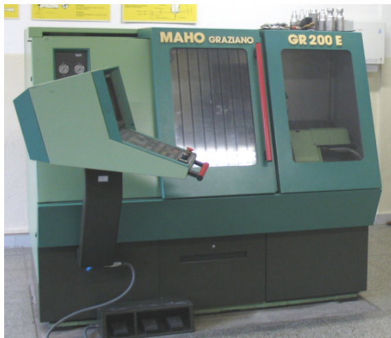
CNC-Drehmaschine MAHO Graziano GR 200 E
